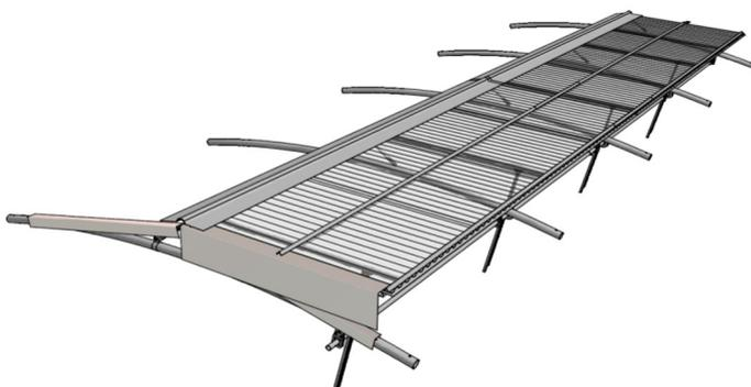
Le lastre sono fissate al telaio della struttura metallica mediante viti autoforanti secondo il capitolato di posa proposto dal fornitore come segue:
